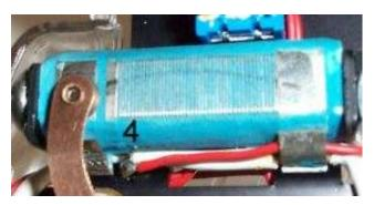
Nun ist Ihr PLUS/TURBO fertig und ist zwischen 3 Werten schaltbar. Schließen Sie den Regler an Ihre Bahn an. Lassen Sie dabei erst mal den Bremsanschluss (rotes Kabel) weg und testen den Regler ohne Bremse. Funktioniert er einwandfrei, dann schließen Sie die Bremse an und testen, ob jetzt ein Kurzschluss besteht. Wenn nein, ist alles ok. Wenn ja, dann kontrollieren Sie die Verdrahtung.
