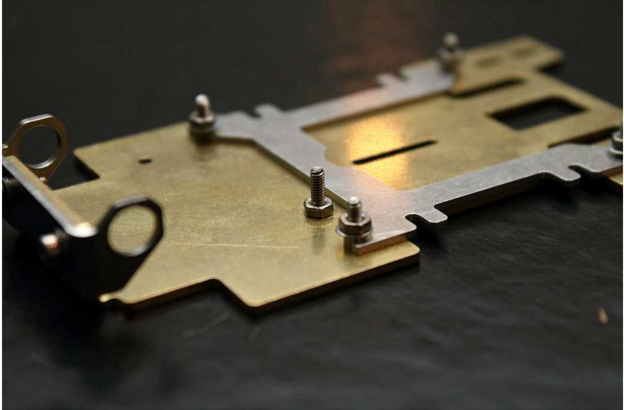
Die 2-te Mutter gegen die Befestigungsmutter festschrauben. Metallunterlegscheibe auf die Mutter legen.
