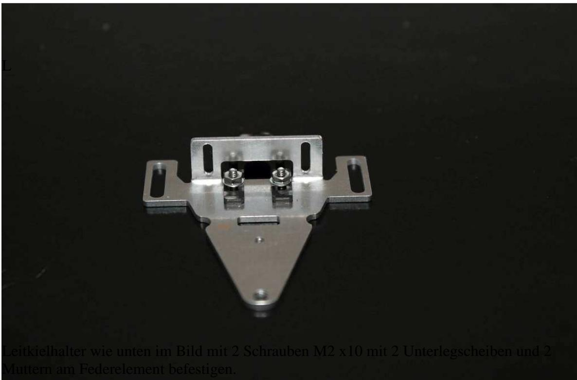
Leitkielhalter wie unten im Bild mit 2 Schrauben M2 x10 mit 2 Unterlegscheiben und 2 Muttern am Federelement befestigen.
